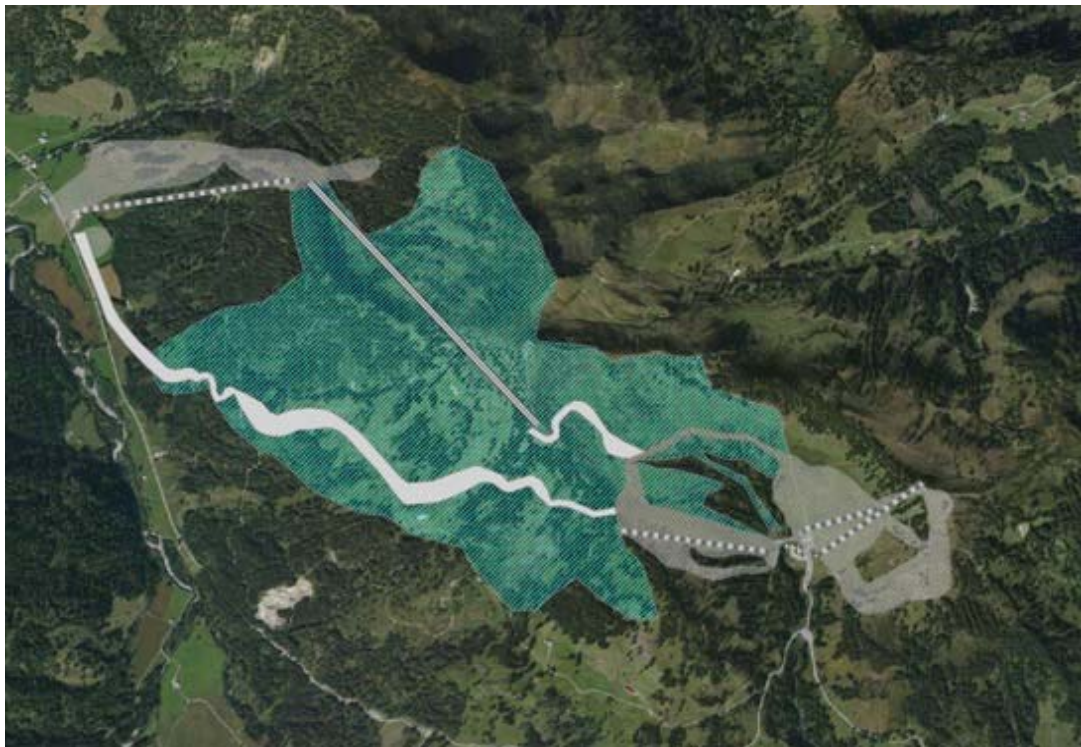
Abb. 10: SO-Seilbahn (graue Linie), Pistenflächen neu (graue Fläche) und wahrscheinliches Einzugsgebiet von Freeride- / Variantenski- / Snowbaordaktivitäten (blaue Schraffur)
