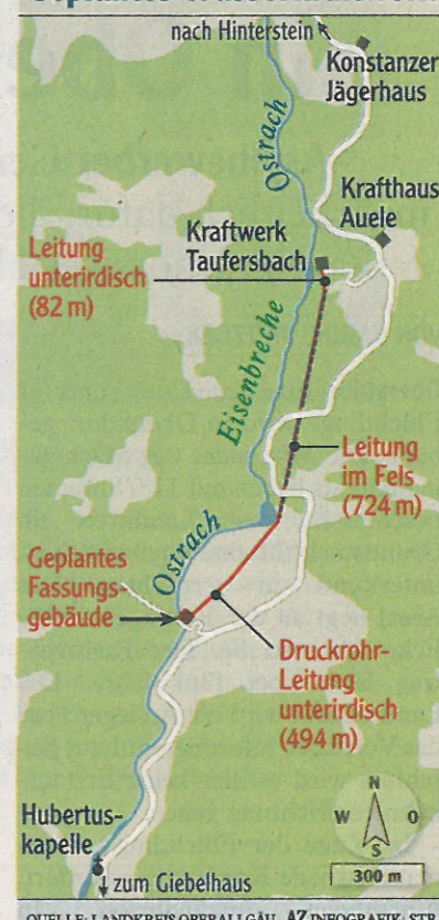
Nahe der Ortswanger Brücke im Hintersteiner Tal soll das Stauwehr (Fassungsgebäude) für die Wasserkraftanlage „Äpele“ gebaut werden. Naturschützer befürchten, dass sich dadurch Feinschlamm ansammelt, der im Staubecken und noch viele Kilometer flussabwärts den Bachgrund versiegelt und verklebt.
